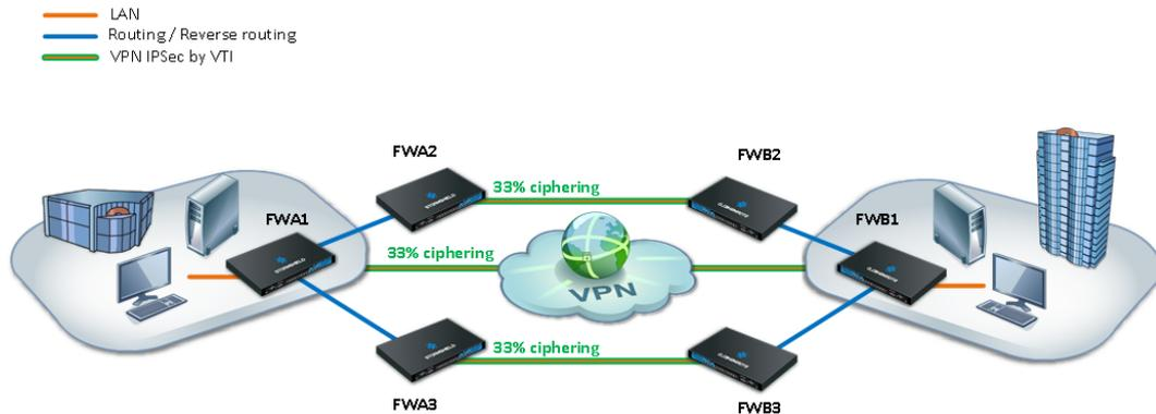
Le premier cas proposé dans cette note technique utilise les objets routeurs et routes de retour afin de distribuer les tunnels IPSec sur plusieurs firewalls, répartissant ainsi les ressources système nécessaires au chiffrement / déchiffrement des données.
